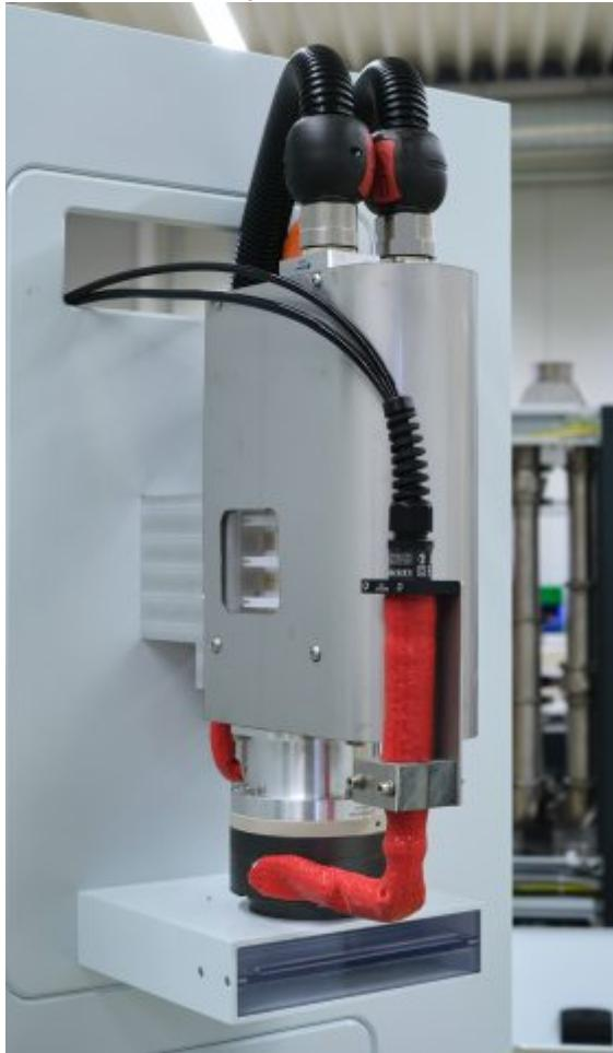
Neue Rotations-Plasmadüse zur flächigen Beschichtung (Bild: Plasmatreat).
