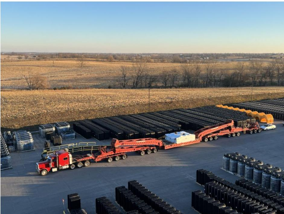
Für viele der Maschinenkomponenten wurden Spezialtransporter benötigt. Das Bild zeigt eine der 117 t schweren festen Aufspannplatten bei der Ankunft im Infiltrator Werk in Kentucky (Bild: Engel).
