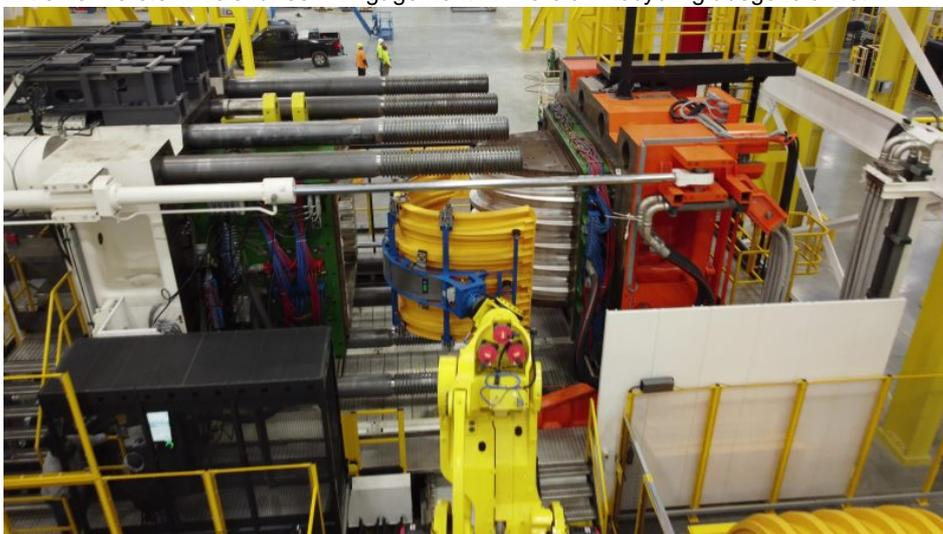
Die Großbauteile mit einem Schussgewicht von bis zu 122 kg werden automatisiert aus dem Werkzeug entnommen (Bild: Engel).
