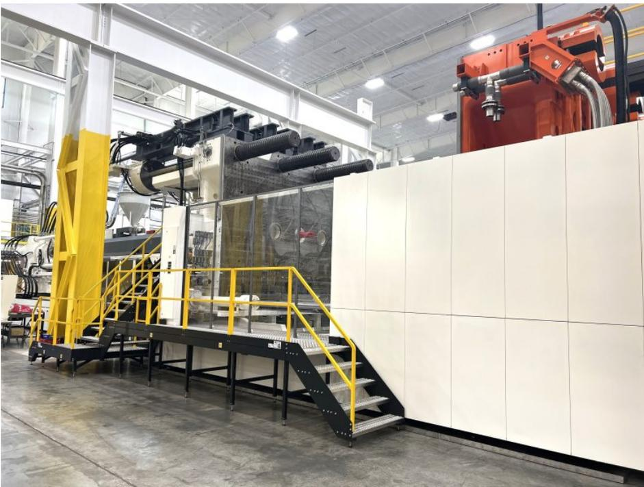
Ein Blick auf den Werkzeugraum verdeutlicht die Größe der Maschine. Insgesamt bringt sie es auf eine Länge von 29,3 m (Bild: Engel).
