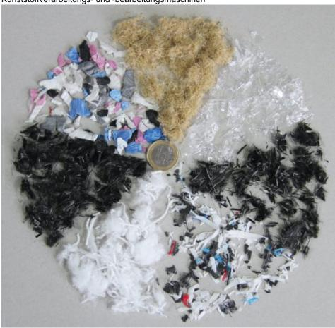
Bei der Verarbeitung von Karbonfaserplatten fällt oft sehr viel Verschnitt an, der bislang entsorgt werden musste. Mit dem Dosierer »FiberXpert« von Brabender Technologie ist damit Schluss, denn er ist in der Lage, die heterogenen und langen Fasern zu dosieren. Damit wird ein wirtschaftlich und ökologisch sinnvolles Recycling erst möglich. Bis zu 40 % Verschnitt bedeuten einen erheblichen Kostenfaktor. Doch durch das Schreddern der
