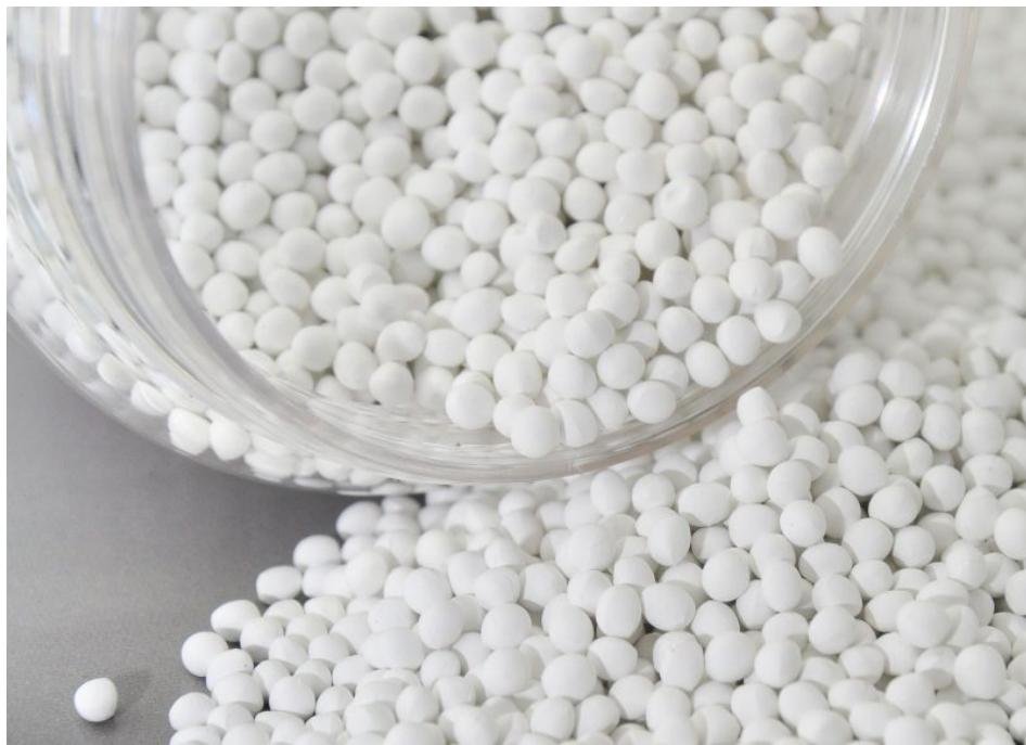
Die neuen weißen Masterbatches eignen sich z. B. zur Herstellung von Hart- und Weichverpackungen für die Lebensmittelindustrie (Bild: Tosaf).
