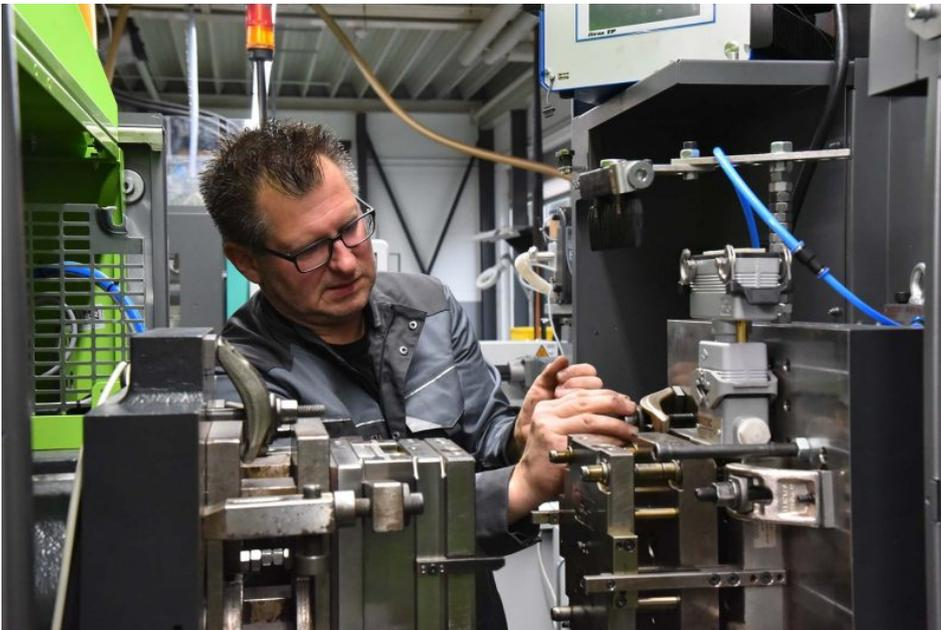
Um eine Spritzgießmaschine pünktlich umrüsten zu können, muss das fertige Werkzeug zur Verfügung stehen. Planung und Organisation werden über die Softwarelösung abgewickelt (Bild: IKOffice).
