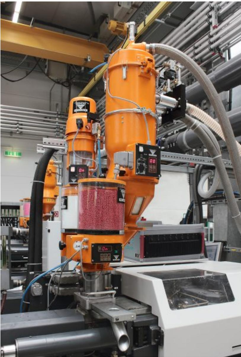
Beim Einfärbegerät »KEM« wird die Hauptkomponente über einen freien Zulauf beigegeben. Zwei Stationen werden verwendet, wenn zusätzlich zur Einfärbung mit Masterbatch auch noch Additive zudosiert werden. Hier wird als Hauptkomponente neben Neuware noch prozentantilig Mahlgut beigegeben (Bild: Koch-Technik).
