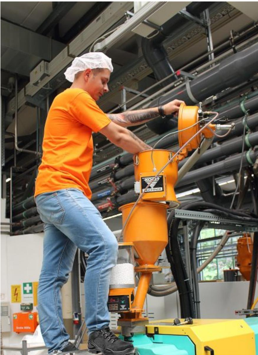
Die Geräte sind modular aufgebaut und können in einem Baukastensystem zusammengestellt werden. Die Förderhauben lassen sich klappen und der Förderkörper seitlich wegschwenken – direkt auf der Maschine und völlig ohne Werkzeug (Bild: Koch-Technik).
