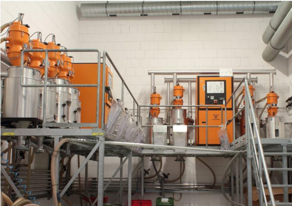
Die Trocknungsanlage in Werk 2 befindet sich auf einer speziell angefertigten Bühne in drei Meter Höhe über dem Materiallager. Die Anlagensteuerung sorgt dabei für höchstmögliche Energieeinsparung gepaart mit einem Schutz vor Übertrocknung des thermisch empfindlichen Materials (Bild: Koch-Technik).
