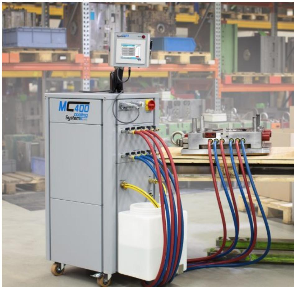
Das Werkzeugprüfgerät »Mold Check« von Stemke Cooling Systems vereint Dichtheitsprüfung und Durchflussmessung in einem Gerät. Anwender müssen also die bis zu sechs vom Werkzeugprüfgerät unterstützten Wasserkreisläufe nur einmal mit dem Gerät verbinden. Der Test verläuft dann über die intelligente Benutzerführung selbsterklärend und automatisch. Das Gerät ermöglicht Druckluftspülung,
