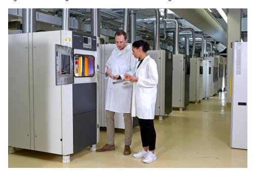
Laborbewitterung von Kunststoffen trägt dazu bei, die Entwicklung lichtabbaubarer Kunststoffe durch vergleichbare und wiederholbare Bewitterungsdaten zu unterstützen (Bild: Atlas Material Testing).
