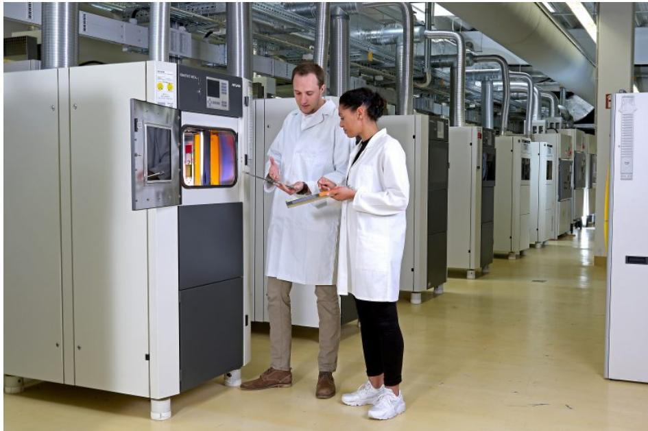
Laborbewitterung von Kunststoffen trägt dazu bei, die Entwicklung lichtabbaubarer Kunststoffe durch vergleichbare und wiederholbare Bewitterungsdaten zu unterstützen (Bild: Atlas Material Testing).
