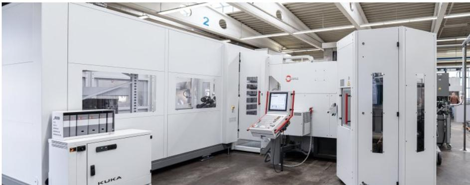
Zwei 5-Achs-Bearbeitungszentren verbunden mit einem Robotersystem geben der Hohner Maschinenbau GmbH die notwendige Flexibilität für ihr besonders vielfältiges Teilespektrum (Bild: Hermle).
