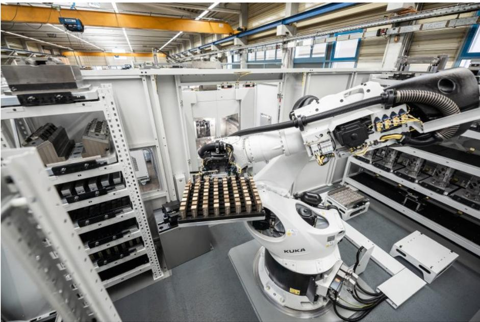
Der Roboter bestückt zuverlässig die beiden 5-Achs-Bearbeitungszentren – auch in den personenlosen Schichten (Bild: Hermle).
