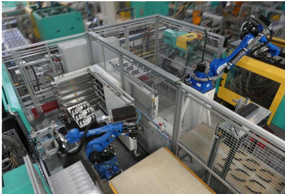
Dank 6-Achs-Roboter können 2K-Bauteile auf zwei 1K-Spritzgießmaschinen effizient gefertigt werden (Bild: Weiss Kunststoffverarbeitung).
