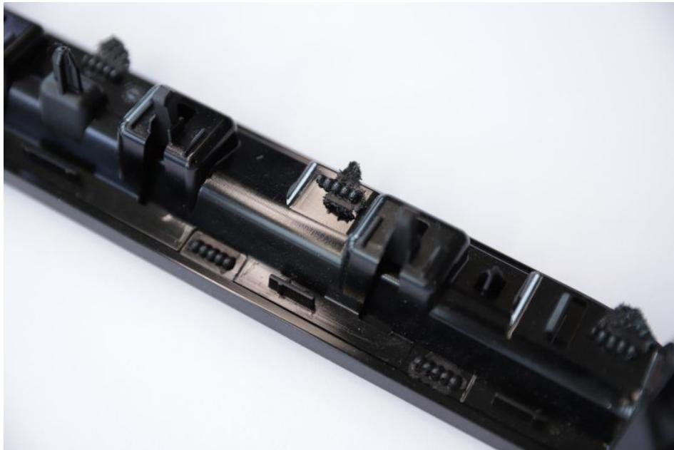
Raupenkalotte: oben geschweißt auf einer pneumatischen Maschine (Materialaustritt), unten auf einer elektrischen Maschine mit optisch überzeugendem Schweißresultat (Bilder: Rinco).
