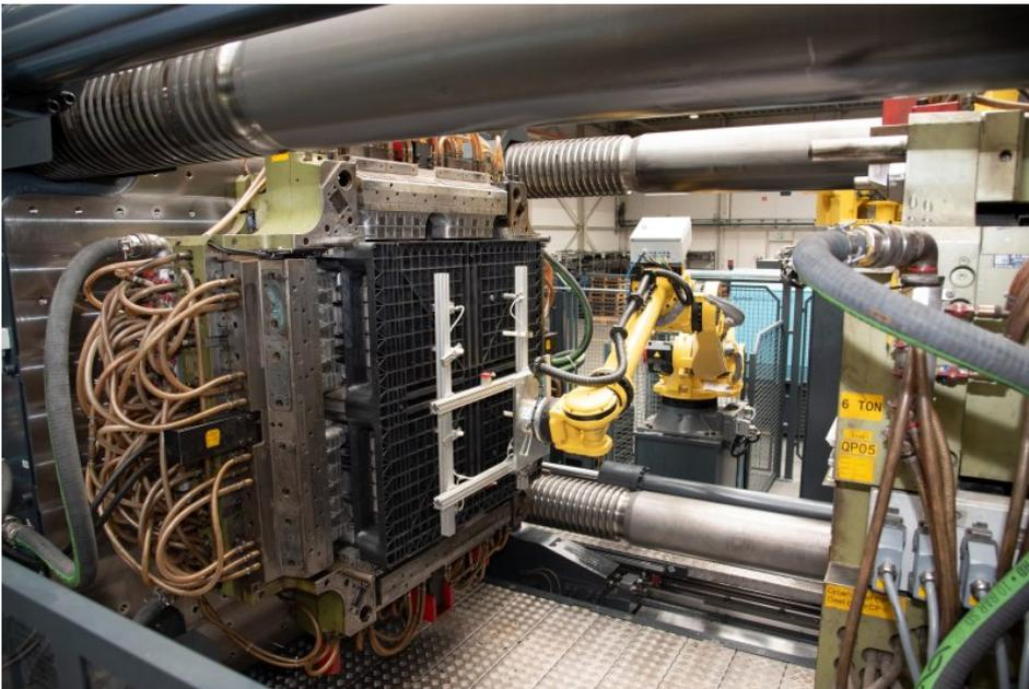
Bei der Palettenproduktion aus Post-Consumer-Rezyklat wird während des Zyklus kontinuierlich plastifiziert und über ein Kolbenaggregat der Kavität zugeführt. Die Entnahme sowie die Ablage der Palette erfolgen automatisiert (Bild: Engel).
