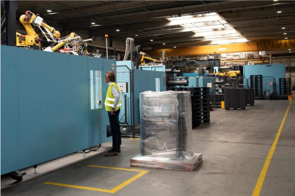
Größenvergleich: Die neue »duo 2300« von Engel mit Zwei-Stufen-Prozess baut gleich mehrere Meter kürzer als das ältere Schwestermodell ganz am Ende der Produktionshalle – für AVK mit ein wichtiges Kaufkriterium (Bild: Engel).
