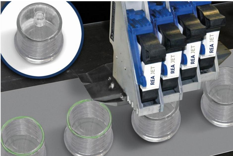
Der Tintenstrahldrucker appliziert punktgenau Spezial-Primer für das Laserschweißen (Bild: Rea).
