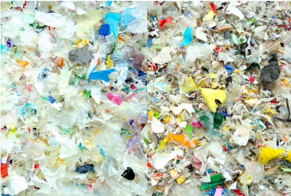
Fraktionen nach der Windsichtung: rezyklierbares PE (li.) und Materialmischung mit Mehrschichtfolien (Bilder: Pla.to)
