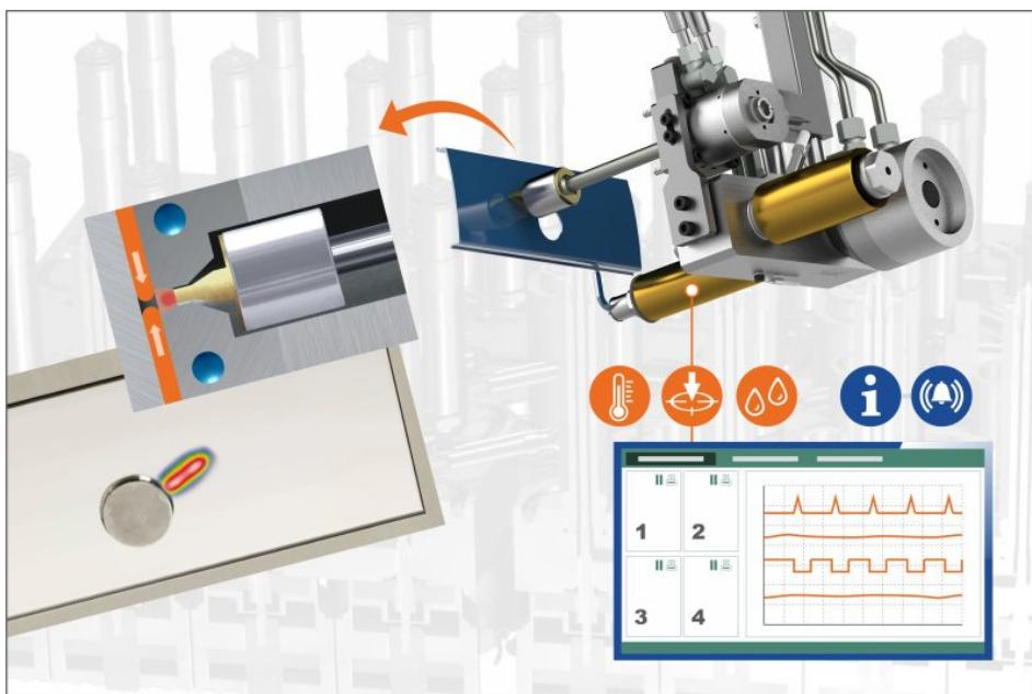
Dynamisch punktuelle Werkzeugtemperierung und Prozessdatenerfassung erweitern die Funktionen des Heißkanals (Bild: Incoe).
