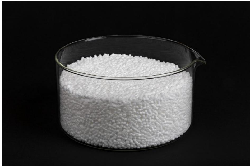
Das Additiv erleichtert die Herstellung verarbeitungsfähiger Polyethylen-Formmassen und verbessert die Oberflächeneigenschaften der daraus hergestellten Kunststoffartikel (Bild: Wacker).
