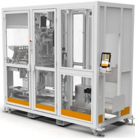
Neue Lösung zur vollautomatischen Montage von Metallbügeln an Kunststoffeimern
