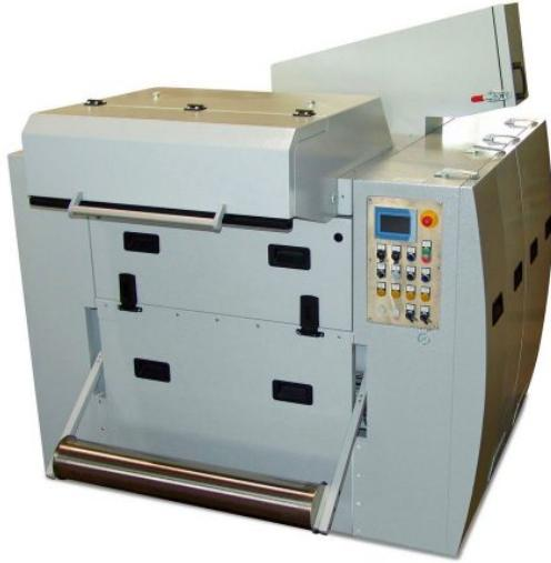
Die Einzugsmühle kommt bei der Stanzgitter-Zerkleinerung im Thermoforming zum Einsatz (Bild: Getecha).
