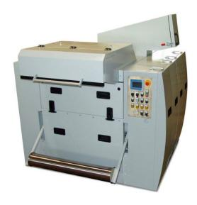
Die Einzugsmühle kommt bei der Stanzgitter-Zerkleinerung im Thermoforming zum Einsatz (Bild: Getecha).
