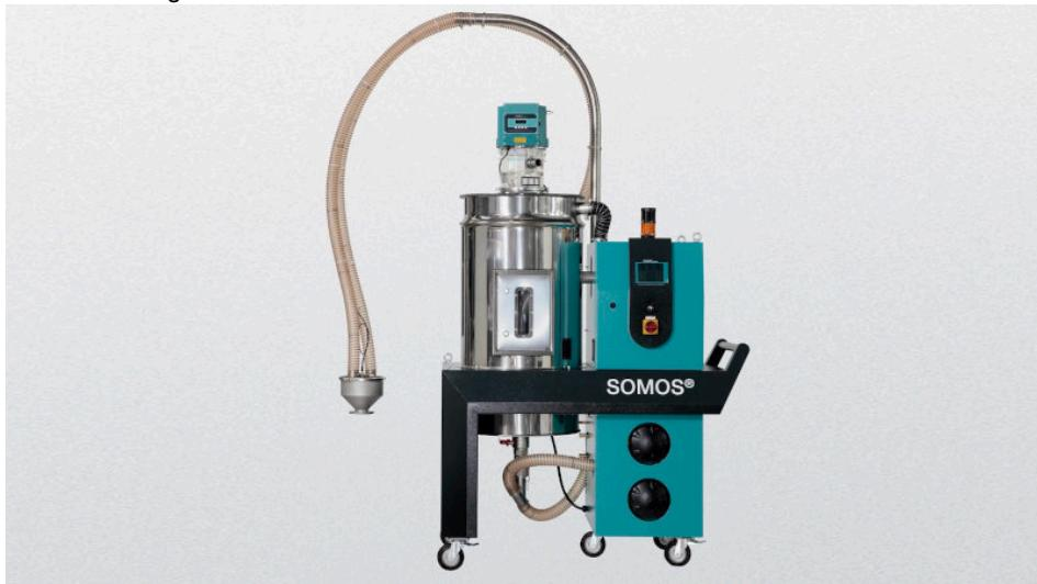
Die mobilen Granulattrockner eignen sich als flexible Beistelleinheit für Verarbeitungsmaschinen und bei Auftragsspitzen (Bild: ProTec).
