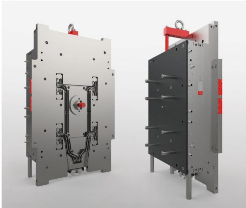
Der vollelektrische Kaltkanal ermöglicht das Ausbalancieren beim Füllen von Mehrfachwerkzeugen mit bis zu 16 Kavitäten (Bild: Elmet).
