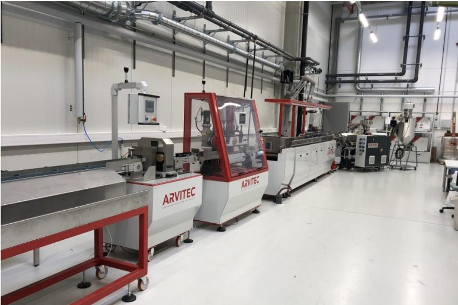
Die Co-Extrusionsanlage von Arvitec erweitert die technischen Möglichkeiten für Entwicklungsprojekte (Bild: Teknor Germany).
