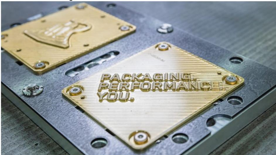
Mit Wechselplatten entfällt bei Wiederholaufträgen die Einrichtung der Heißfolienprägeklischees zum Druckbild (Bild: Marbach).
