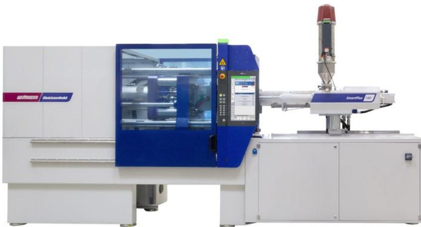
Die »smarte« Spritzgießmaschine wurde für Standardanwendungen entwickelt (Bild: Wittmann).
