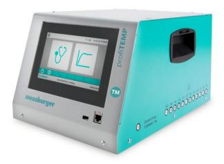
Das kompakte Heißkanal-Diagnosegerät kann 12 Zonen überprüfen sowie aufheizen und vorwärmen (Bild: Meusburger).
