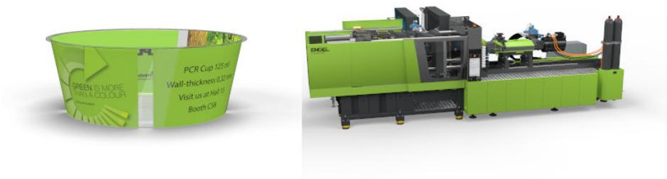
Dank neuer Hochleistungsspritzeinheit lassen sich Dünnwandbehälter aus PET und rPET produzieren (Bild: Engel).
