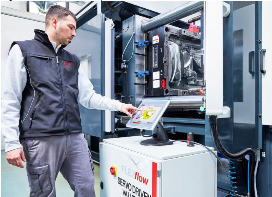
Die Mensch-Maschine-Schnittstelle wurde grundlegend überarbeitet (Bild: Oerlikon HRSflow).
