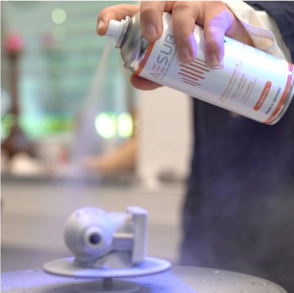
Ein Ventil wird dem Scanningspray besprüht und kann so vom 3D-Scanner besser erfasst werden (Bild: Aesub).
