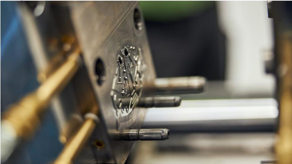
Für die Produktion des Steckmoduls in Reinraumqualität wurde ein härteres Alu-Werkzeug entwickelt (Bild: 1zu1).
