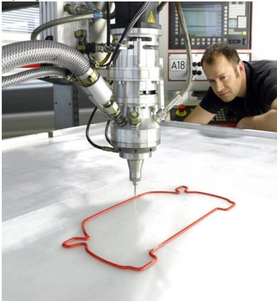
Die Polyurethan-Dichtungsschäume »RAKU PUR 32-3264« und »RAKU PUR 32-3278«
