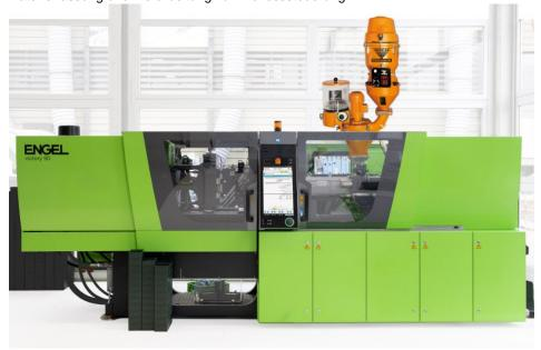
Über OPC UA können auch Dosier- und Mischgeräte in die Steuerung der Spritzgießmaschinen integriert werden (Bild: Engel).
