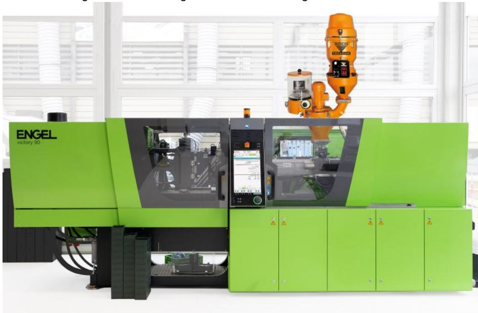
Über OPC UA können auch Dosier- und Mischgeräte in die Steuerung der Spritzgießmaschinen integriert werden (Bild: Engel).
