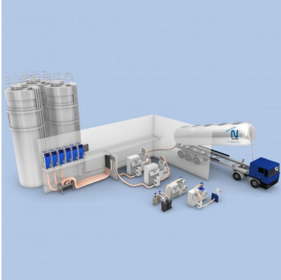
Die Kunststoffverarbeitung ist ein vielschichtiger Prozess. Zwischen den einzelnen Verarbeitungsstufen werden Granulate oder Pulver meist über lange Strecken hinweg mittels Schlauchleitungen transportiert, die starker Beanspruchung standhalten müssen. Damit die Produktionsprozesse effizient und reibungslos funktionieren, ist die Auswahl
