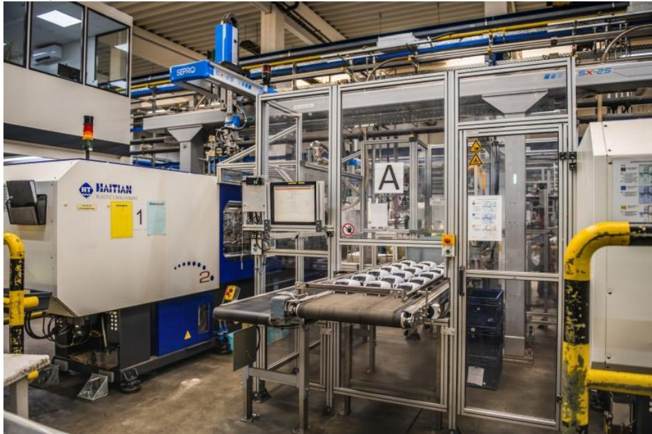
Gefertigt wird das 2K-Bauteil vollautomatisch auf zwei Spritzgießmaschinen mit 200 t Schließkraft (Bild: GS Kunststofftechnik).
