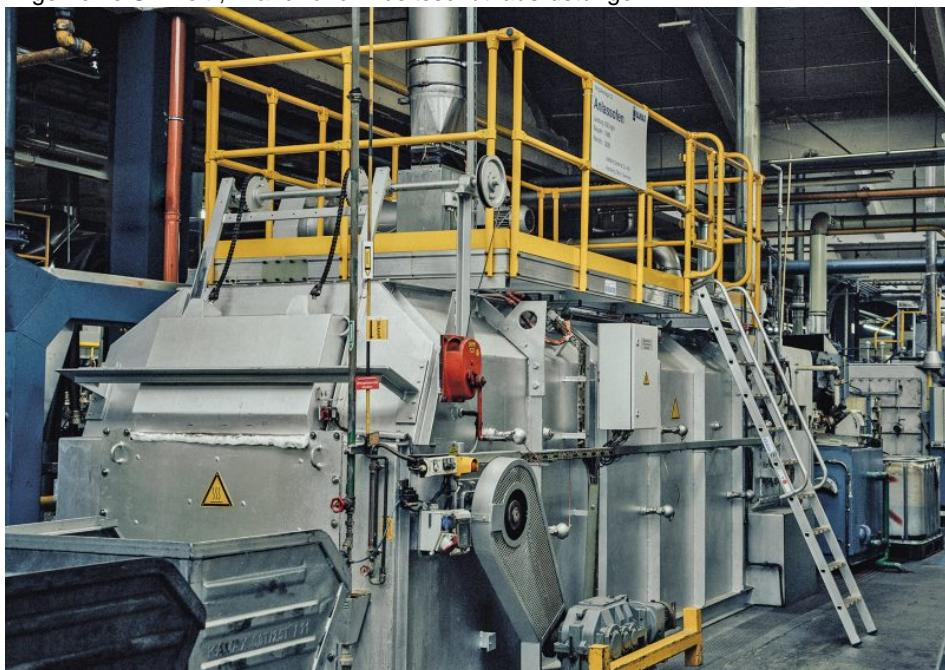
Die Laufflächen der Arbeitsplattformen wurden aus Gitterrosten der Rutschhemmkategorie R13 realisiert (Bild: Krause).
