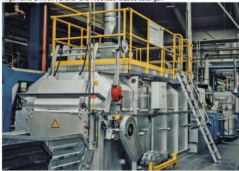
Die Laufflächen der Arbeitsplattformen wurden aus Gitterrosten der Rutschhemmklasse R13 realisiert (Bild: Krause).
