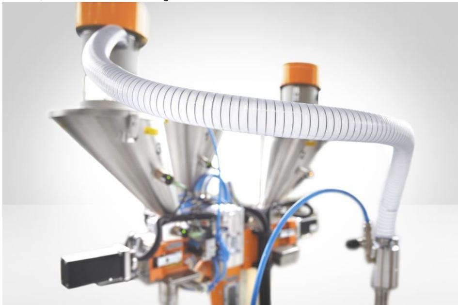
Volumetrische Farbwechselanlage mit Venturi-Fördergeräten und automatischer Reinigung (Bild: Woywod).
