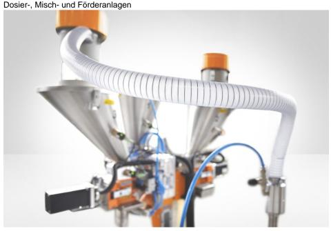
Volumetrische Farbwechselanlage mit Venturi-Fördergeräten und automatischer Reinigung (Bild: Woywod).
