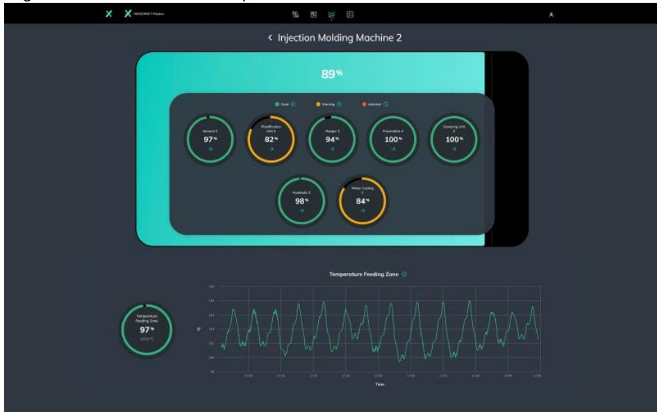
Die KI-basierte Prozessüberwachung hilft z. B. dabei, den CO2-Fußabdruck von Kunststoffverarbeitern zu senken (Bild: Technotrans).
