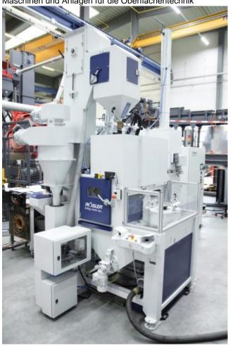
Zwei gegenüberliegende Satelliten ermöglichen, dass während des Strahlens der zweite Satellit ent- und beladen wird (Bild: Rösler).
