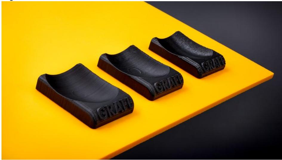
Vergleich eingefärbtes PETG (re.) mit unterschiedlichen Mattierungsmitteln für den 3D-Druck (Bild: Gafe).
