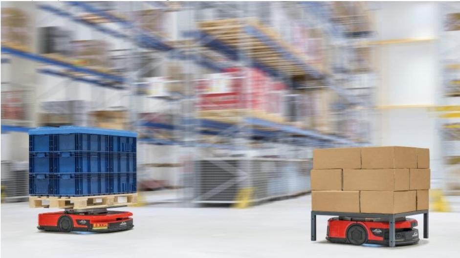
Die kompakten Transportroboter sind agil und fahren autonom durch Lager oder Fertigungsbereiche (Bild: Linde Material Handling).
