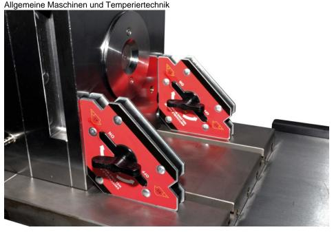
Werkstücke und Formen werden einfach und flexibel von den schaltbaren Magneten gehalten (Bild: Nonnenmann).
