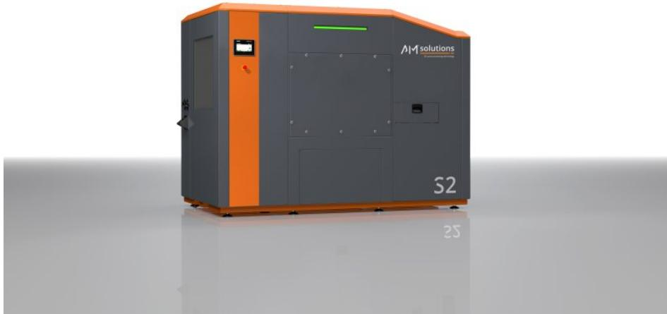
Durchlauf-Strahlanlage zur Nachbearbeitung von 3D-Kunststoffteilen aus pulverbettbasierten Druckverfahren (Bild: AM Solutions/Rösler).
