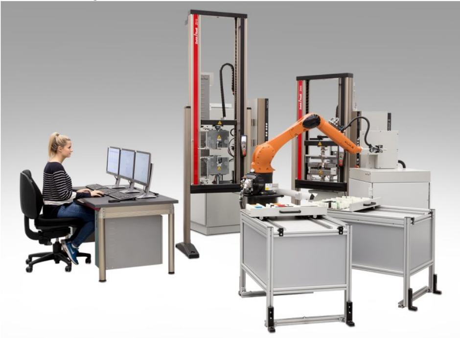
Das Roboter-Prüfsystem liefert reproduzierbare Ergebnisse der Zug- und Biegetests von Kunststoffteilen (Bild: ZwickRoell).
