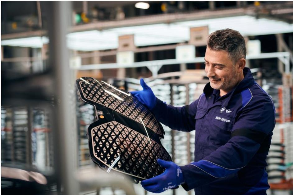
Die Nieren für den neuen BMW iX werden in einer hochintegrierten Reinraumproduktionszelle hergestellt (Bild: Engel).
