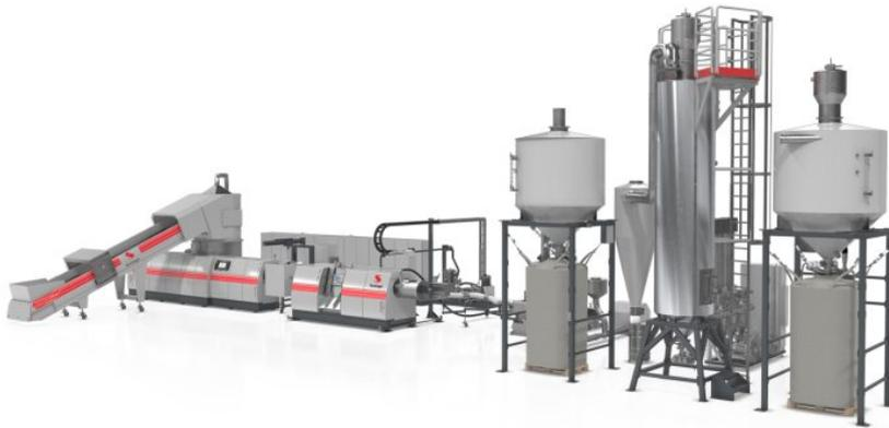
»recoStar dynamic« mit »C-VAC«-Entgasungsmodul und nachgeschalteter Geruchsreduktionstechnologie (Bild: Starlinger).
