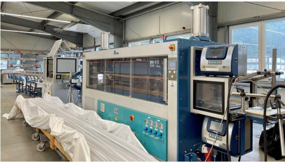
Die beiden neuen Extrusionsanlagen verfügen über maßgeschneiderte Nachfolgeeinheiten für die Kalibrierung, den Abzug und das Cutting der Profile (Bild: SLS).
