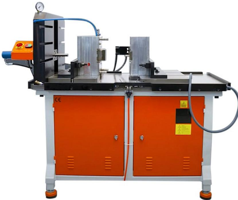
Dank Luftkissenfunktion wird die Werkzeugwartung erleichtert (Bild: Nonnenmann).
