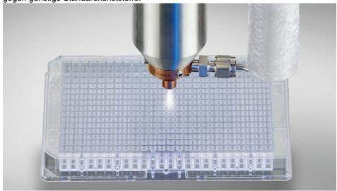
Testkits für Laboranalysen erhalten eine superhydrophobe Beschichtung, die eine vollständige Ausnutzung des Testmediums ermöglicht (Bild: Plasmatreat).
