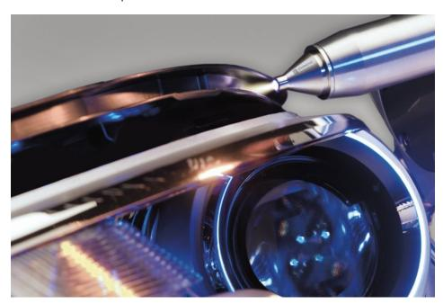
In der Endmontage von Fahrzeugscheinwerfern sorgt die Plasma-Vorbehandlung u. a. für eine zuverlässige Verklebung und sichere Abdichtung der Bauteile (Bild: Plasmatreat).
