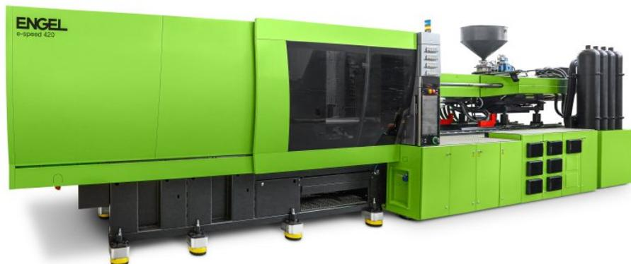
Die neue Spritzgießmaschine »e-speed 420« mit 4200 kN Schließkraft (Bild: Engel).
