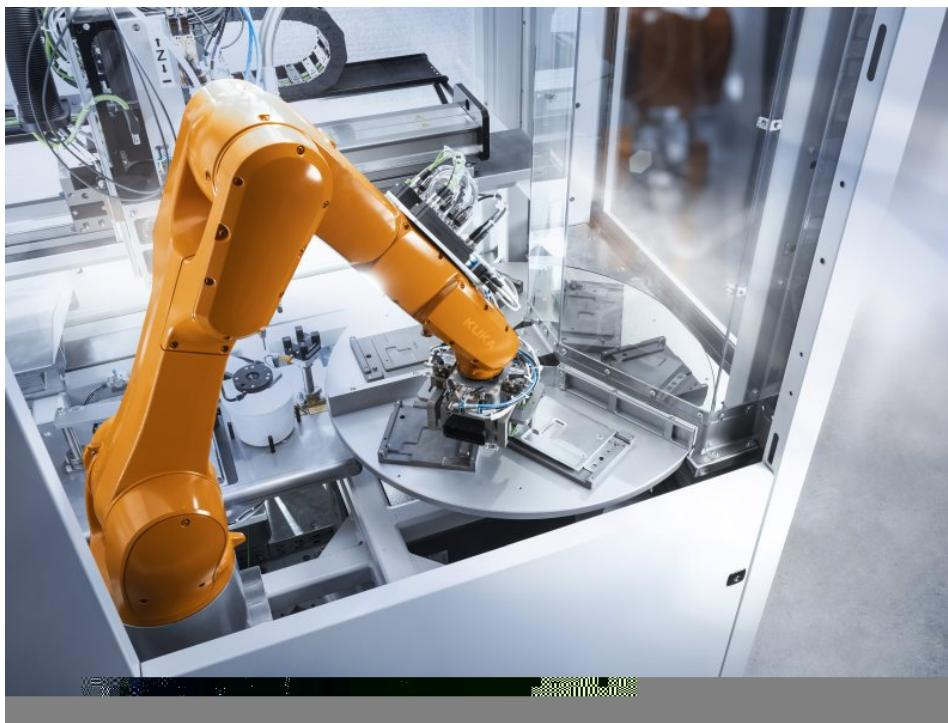
Die Multifunktionszelle wird an die jeweiligen Kundenanforderungen angepasst und integriert Dosier-, Füge- und Prüftechnik (Bild: Rampf).
