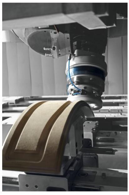
Dank integrierter Druckluftschnittstelle mit Abblas- und Kühlfunktion sind auch spezielle Aggregate einsetzbar (Bild: Felder).
