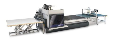
Das neue CNC-Bearbeitungszentrum für Nesting-Anwendungen in der Kunststoffverarbeitung ist in fünf Baugrößen erhältlich (Bild: Felder).
