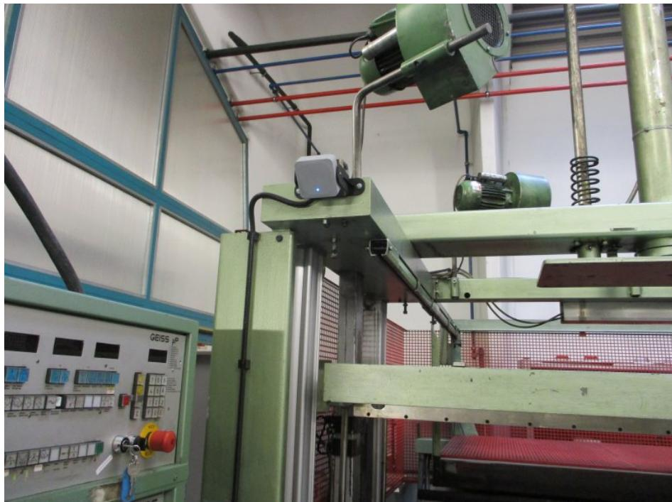
Durch die Retrofit-Maßnahme erkennt das sichere Radarsystem das Betreten des Gefahrenbereichs und löst den sicheren Zustand der Maschine aus (Bild: Pilz, Senoplast).
